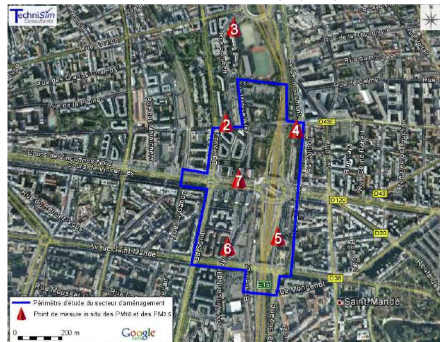
Emplacements des points de mesure in situ des particules en suspension
