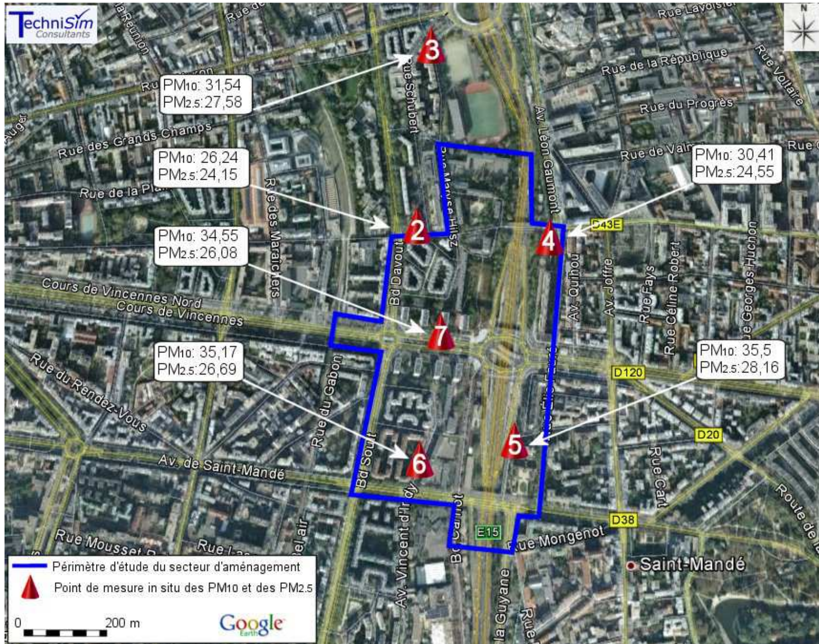
Résultats des mesures in situ pour les poussières en suspension – teneurs en µg/m 3
